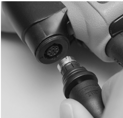
Figuur 1. Als u het accessoire wilt plaatsen, neemt u de kant waar de aansluiting zit vast (zoals weergegeven in Figuur 1), houdt u het recht voor de audioadapter die aan de radio is bevestigd en drukt u het accessoire in de adapter.
